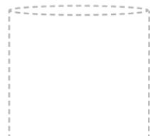
3. Das mitgelieferte Montagerohr (Maße 200 x 90 mm) wird als Schutz vor dem Einbau, Einbetonieren o.ä. über den Sensoradapter gefädelt.
